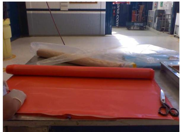
Figura 62. Material base para fabricación de probetas: a) Rollos de fibra preimpregnada, b) Fibra de vidrio preimpregnada lista para cortarse
