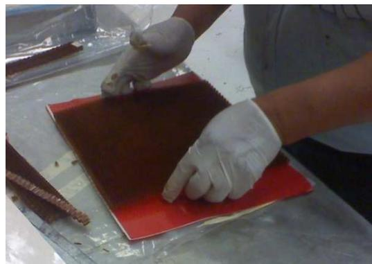
Figura 65. Unión de Honeycomb con capas de fibra de vidrio y capa de adhesivo.
