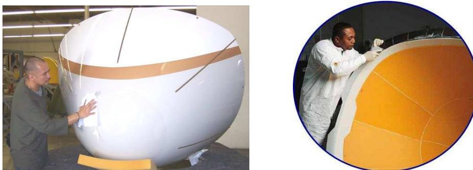
Figura 26. Tipos de radomo comunes. a) Radomo con núcleo de Honeycomb (Nordam). b) Radomo con núcleo Weather master (Cobham advance composites).
