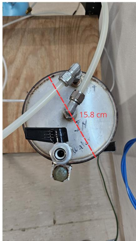
Figura 2: Diámetro del humidificador
