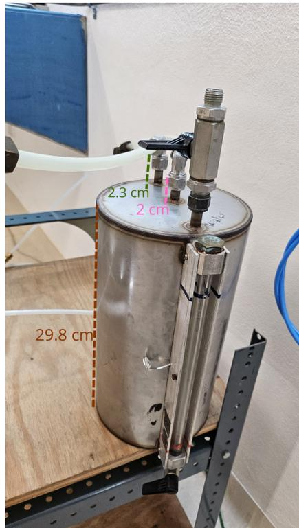
Figura 1: Altura del humidificador y medida de la cantidad que sobresalen los tubos de entrada (rosa) y salida (verde) de gas con respecto a la tapa del humidificador.
